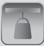
Die Deckensysteme sind hinsichtlich ihrer Durchbiegung und Belastbarkeit nach DIN EN 13964, 2004, geprüft. Die Prüfung entspricht den Feuchte- und Temperaturverhältnissen wie im Annex F Standard vorgeschrieben.
