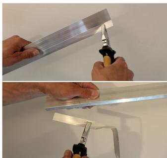
Tagliare da un lato il profilo di base in alluminio in corrispondenza del punto di rottura teorico.
